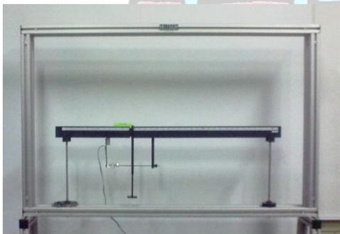
Modelo de Viga HST 10 para momento flexionante instrumentada
